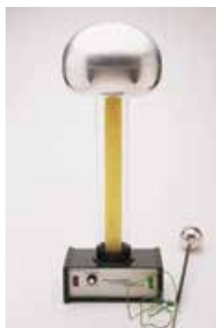
Gerador eletrostático de van de Graaff.
